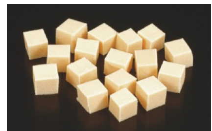
Abb. 2 Testwürfel aus Optosil Comfort Putty
